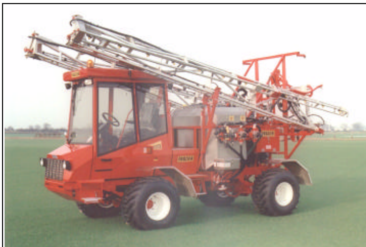
Le Phantom avec son pulvérisateur léger de 1600 litres et de 24m
