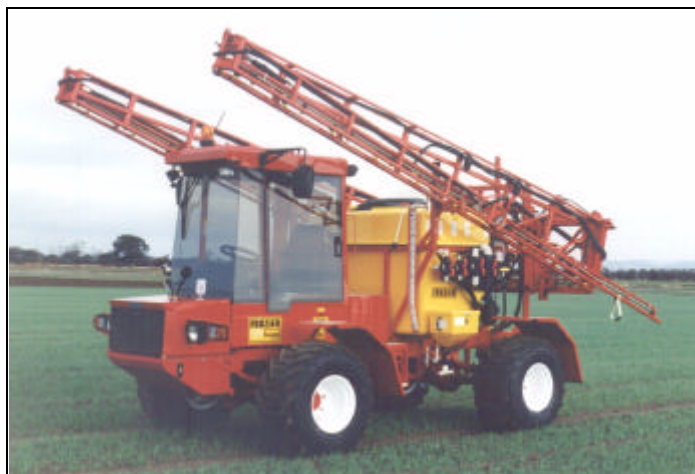
L'Agribuggy 5D avec son pulvérisateur auto-moteur démontable de 1500 litres et ses rampes de pulvérisation de 24 mètres.
