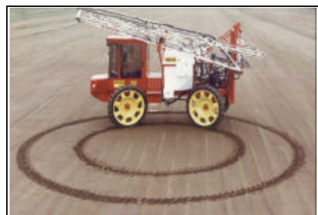
Le 5D avec 4 roues directrices utilisant des roues étroites de 7.2x40.
