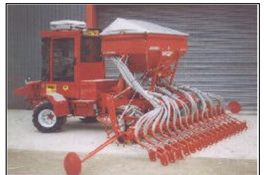
On peut soit fournir le coupe-net de graines soit adapter le coupe-net du client sur la structure démontable de Frazier qui est reliée au véhicule par un système hydraulique
