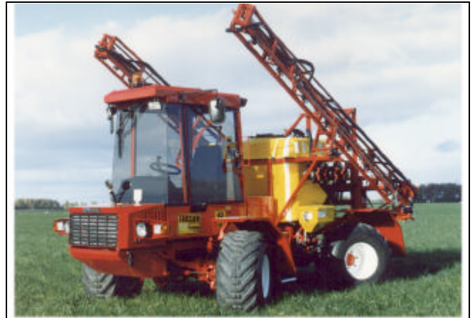
L'Agribuggy 4D avec son pulvérisateur auto-moteur de 950 litres et ses rampes de pulvérisation de 18 mètres avec des roues à basse pression 38x20x16 .
